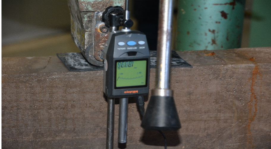
Figura 3 – Detalhe do defletômetro
