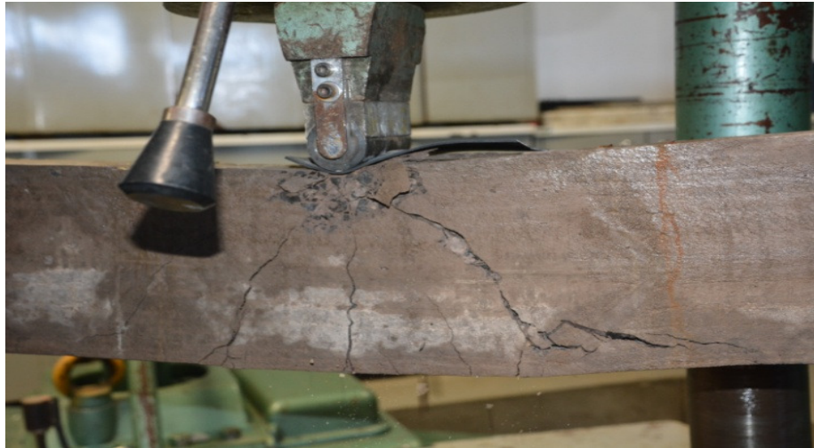
Figura 5 – Ruptura por esmagamento do concreto na viga reforçada com aço
