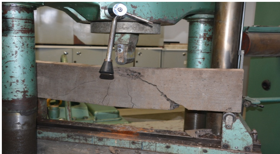
Figura 6 – Ruptura por cisalhamento da viga reforçada com barra em fibra de basalto
