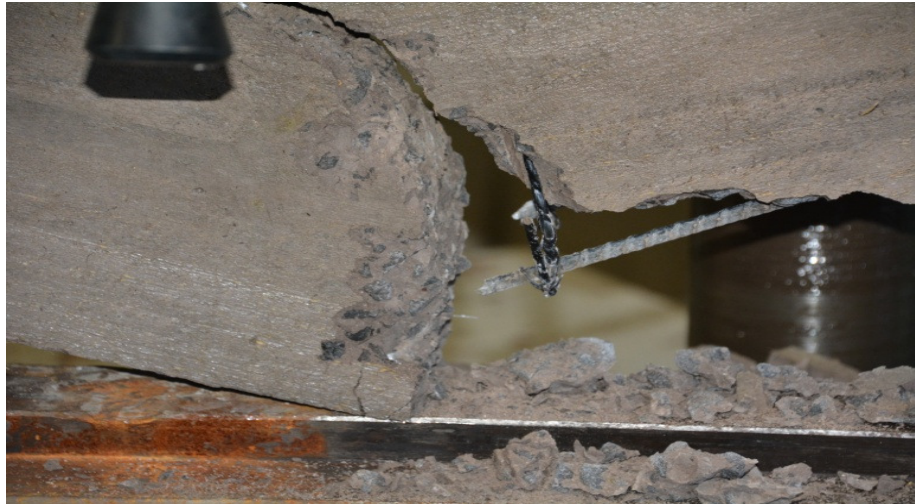
Figura 7 – Ruptura da barra em fibra de basalto
