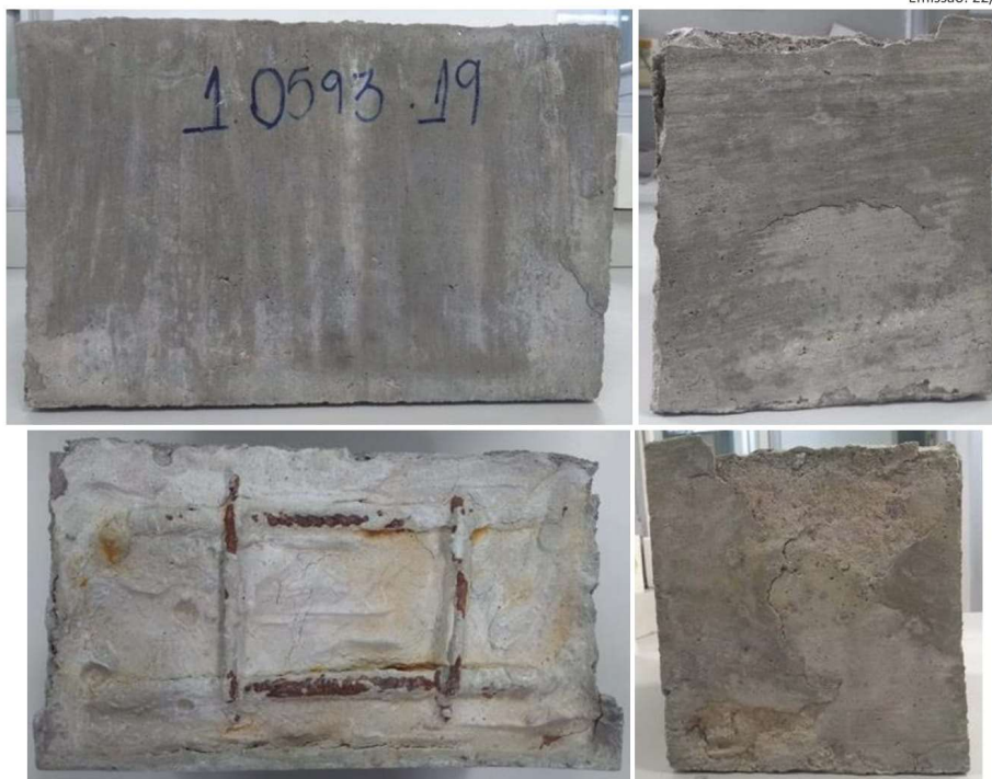
Figura 04: Imagens da amostra 02 após 508 horas de ensaio de exposição à névoa salina neutra.
