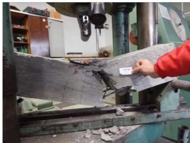
Figura 6 – Ruptura – Carregamento 7100 kgf – Amostra 1.0591.19
