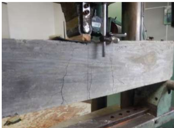
FIGURA 20 – VIGA EM CONCRETO ARMADO COM PRFV SUBMETIDA A UM ESFORÇO DE 5.600 KGF
