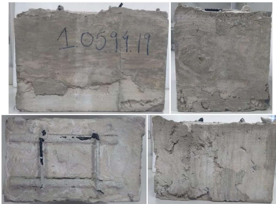
Figura 03: Imagens da amostra 01 após 508 horas de ensaio de exposição à névoa salina neutra.
