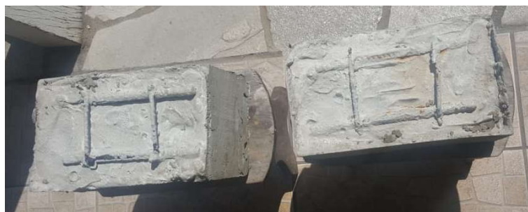
FIGURA 16 – CORPOS DE PROVA PRONTOS PARA O INÍCIO DO ENSAIO DE EXPOSIÇÃO À NÉVOA SALINA
