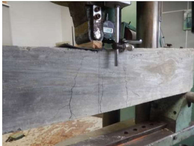
Figura 5 – Fissuras – Carregamento 5600 kgf – Amostra 1.0591.19
