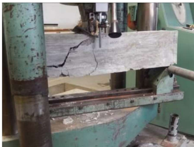
Figura 8 – Fissuras – Carregamento 6400 kgf – Amostra 1.0592.19
