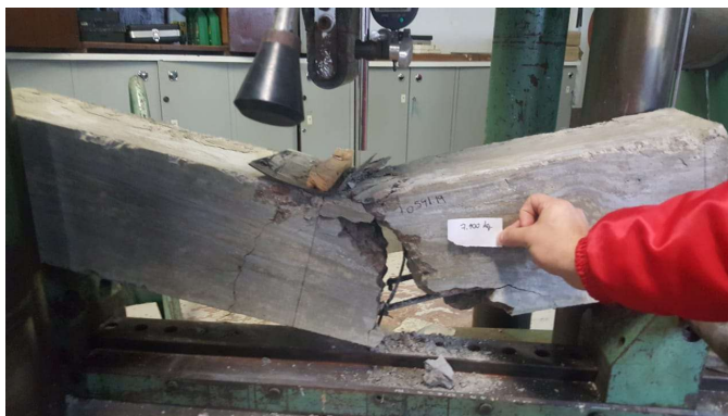
Figura 21 – COLAPSO VIGA EM CONCRETO ARMADO COM PRFV
