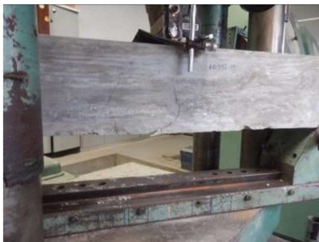
Figura 7 – Fissuras – Carregamento 4800 kgf – Amostra 1.0592.19
