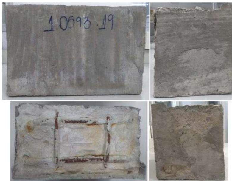
FIGURA 25 – IMAGEM DA AMOSTRA DO CORPO DE PROVA EM CONCRETO ARMADO COM AÇO APÓS O ENSAIO DE 508 HORAS DE EXPOSIÇÃO À NÉVOA SALINA NEUTRA
