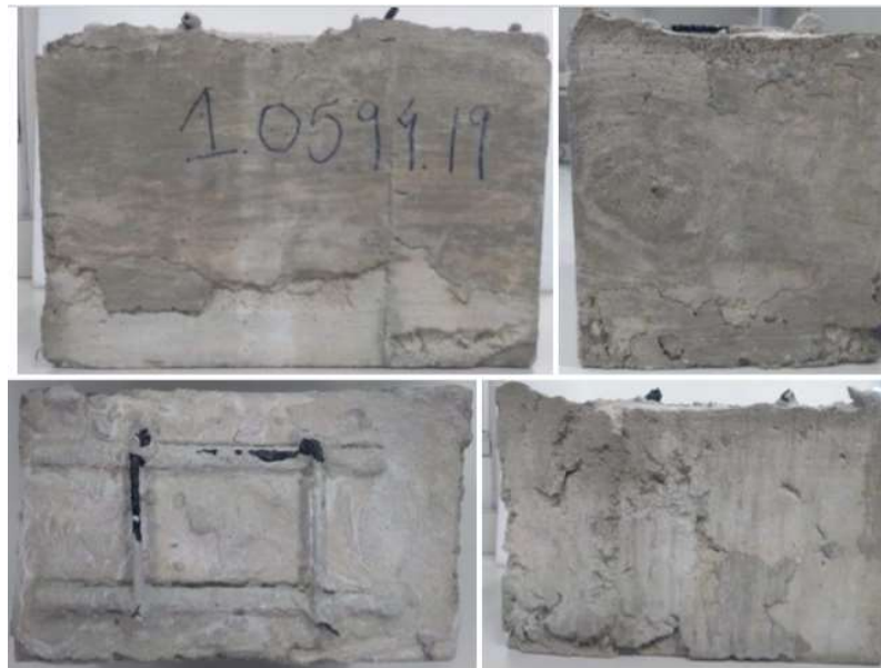
FIGURA 26 – IMAGEM DA AMOSTRA DO CORPO DE PROVA EM CONCRETO ARMADO COM PRFV APÓS O ENSAIO DE 508 HORAS DE EXPOSIÇÃO À NÉVOA SALINA NEUTRA
