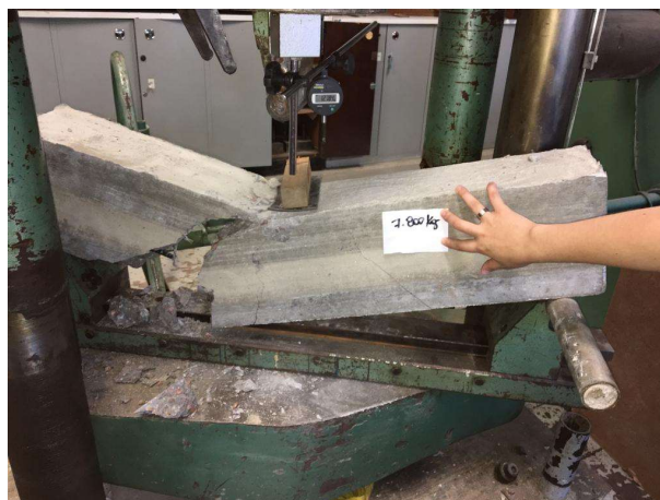
FIGURA 24 – COLAPSO VIGA EM CONCRETO ARMADO COM BARRA DE PRFV E ESTRIBOS DE AÇO CA-60
