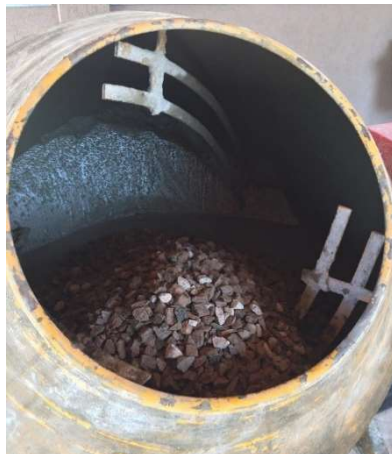
FIGURA 13 – BETONEIRA UTILIZADA PARA O PREPARO DO CONCRETO
