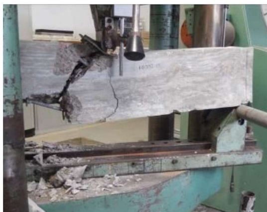
Figura 9 – Ruptura – Carregamento 8250 kgf – Amostra 1.0592.19
