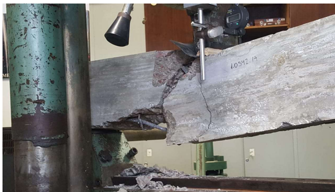
FIGURA 19 – COLAPSO VIGA EM CONCRETO ARMADO COM AÇO
