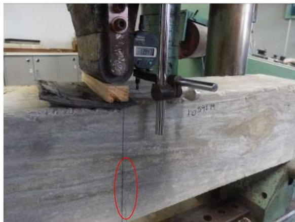
Figura 3 – Fissuras – Carregamento 2000 kgf – Amostra 1.0591.19
