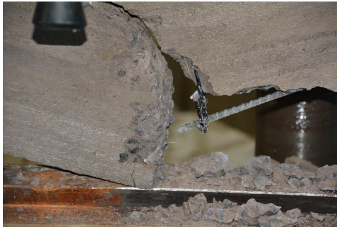
Figura 15: Rompimento da armadura de BRFC (quebra) devido ao cisalhamento.
