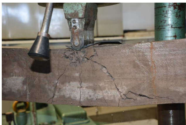
Figura 11: Esmagamento do concreto e escorregamento da armadura na viga convencional. Pode ser indicado também a ruptura por esmagamento na biela comprimida como o esperado pela situação do ensaio.
