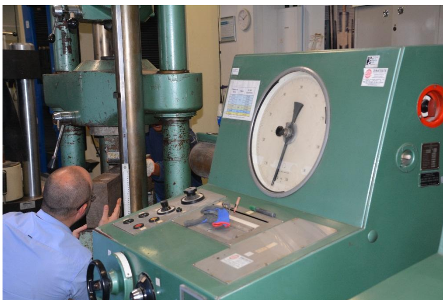
Figura 7: detalhe da máquina universal de ensaios – ZD-100.
