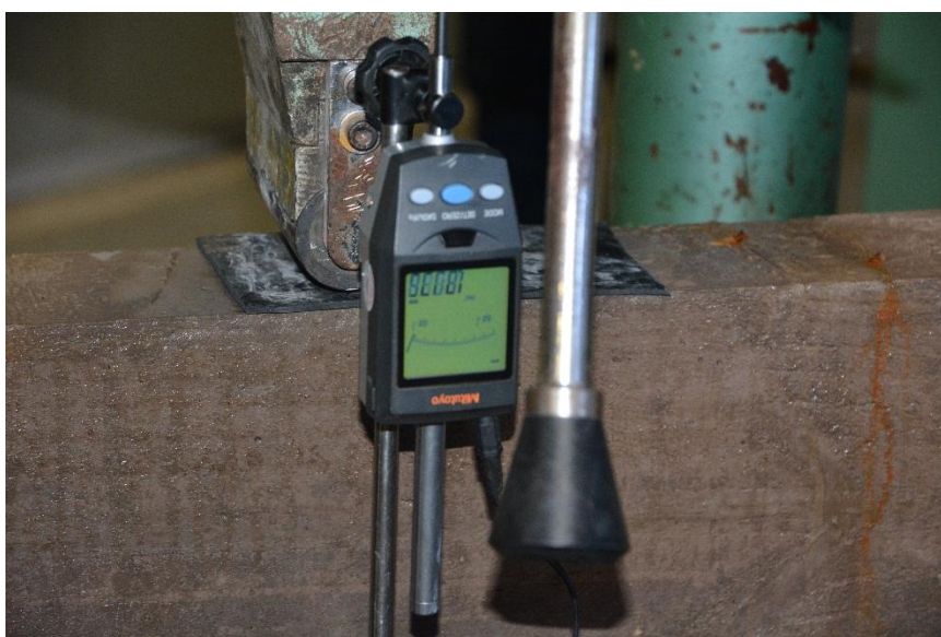
Figura 6: posicionamento do equipamento de leitura de deslocamentos verticais..
