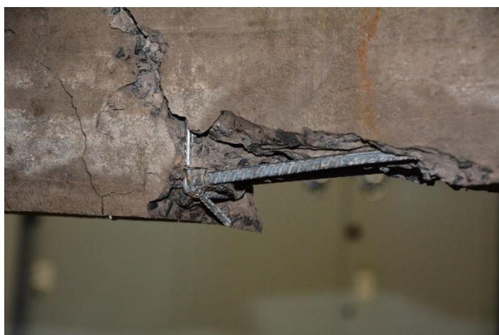
Figura 11: Esmagamento do concreto e escorregamento da armadura na viga convencional. Pode ser indicado também a ruptura por esmagamento na biela comprimida como o esperado pela situação do ensaio.
