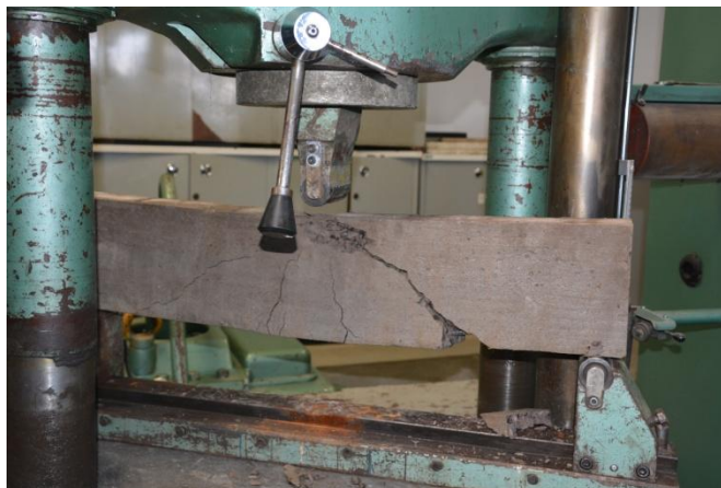
Figura 13: Ruptura na biela comprimida devido ao cisalhamento (caso da viga curta)
